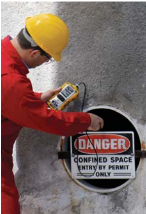
Pruebas en lugares con poco espacio con MultiRAE Lite
