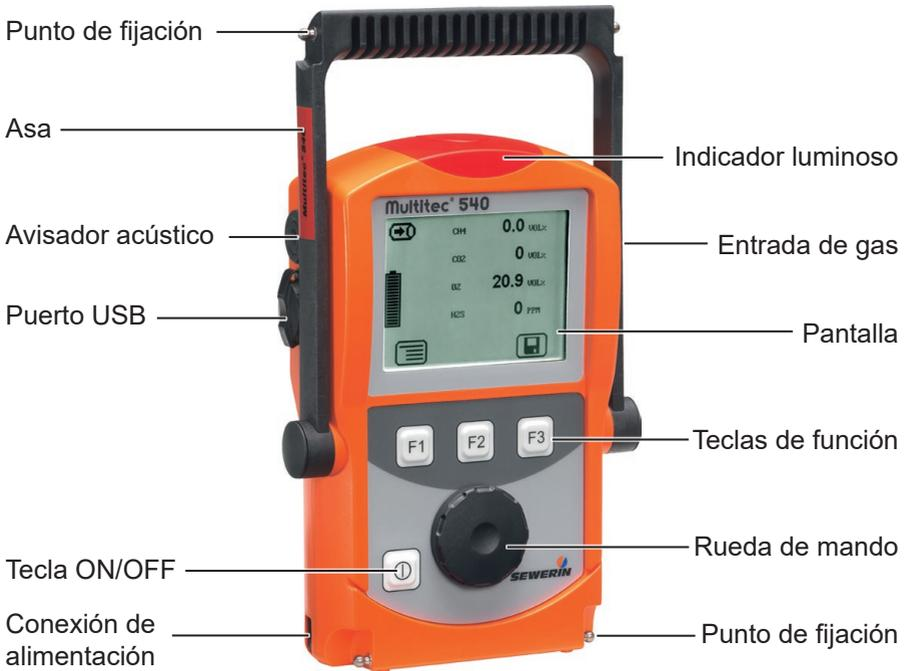
Fig. 1: Vista de conjunto del equipo **Multitec 540**
